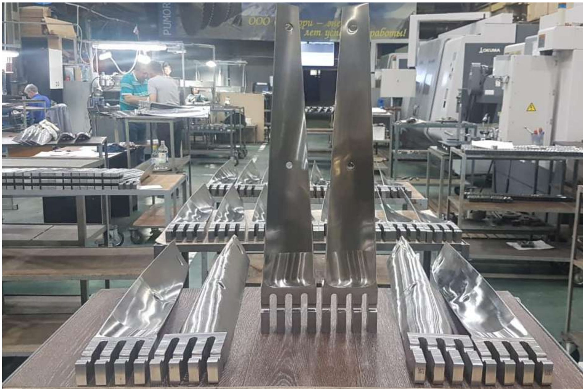
Рабочие лопатки 25 и 27 ст. турбины Т-100-130 (УТЗ)
