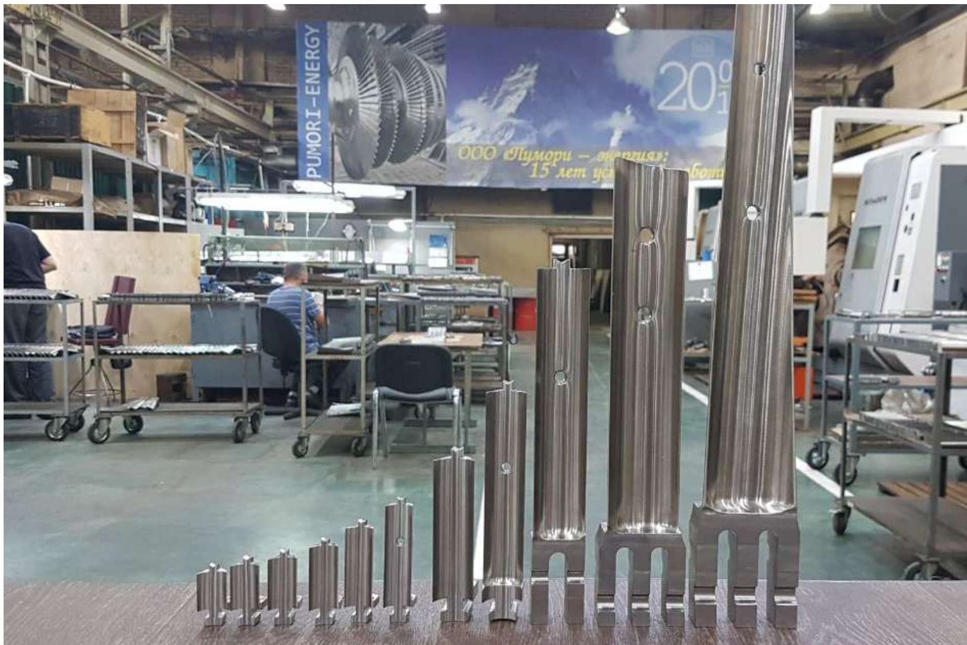
Рабочие лопатки 2-12 ст. паровой турбины K-15-41 (НЗЛ)
