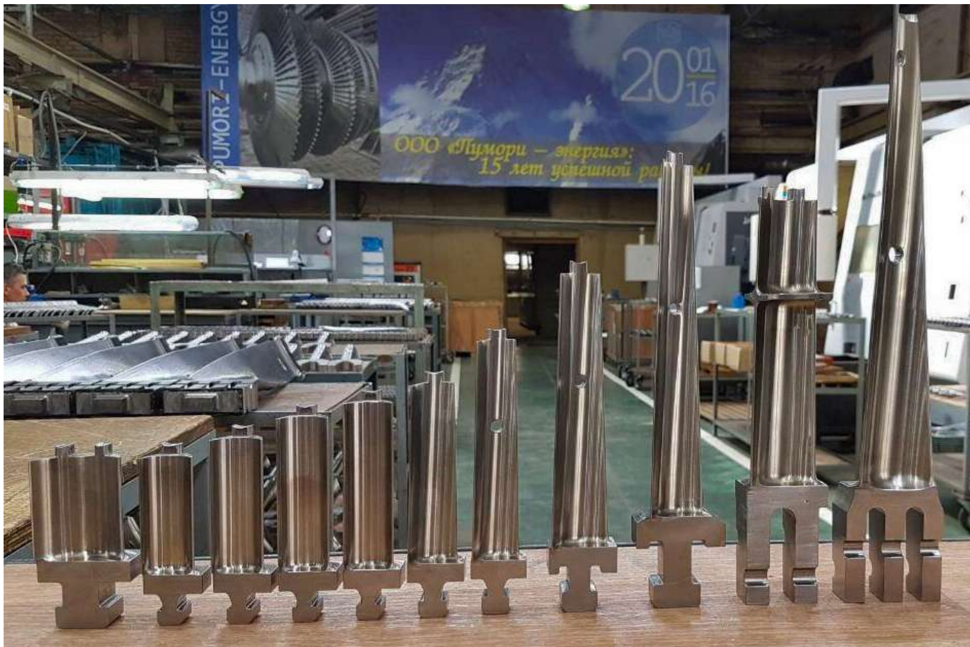
Рабочие лопатки 16-26 ст. турбины ПТ-60-90 (ЛМЗ)
