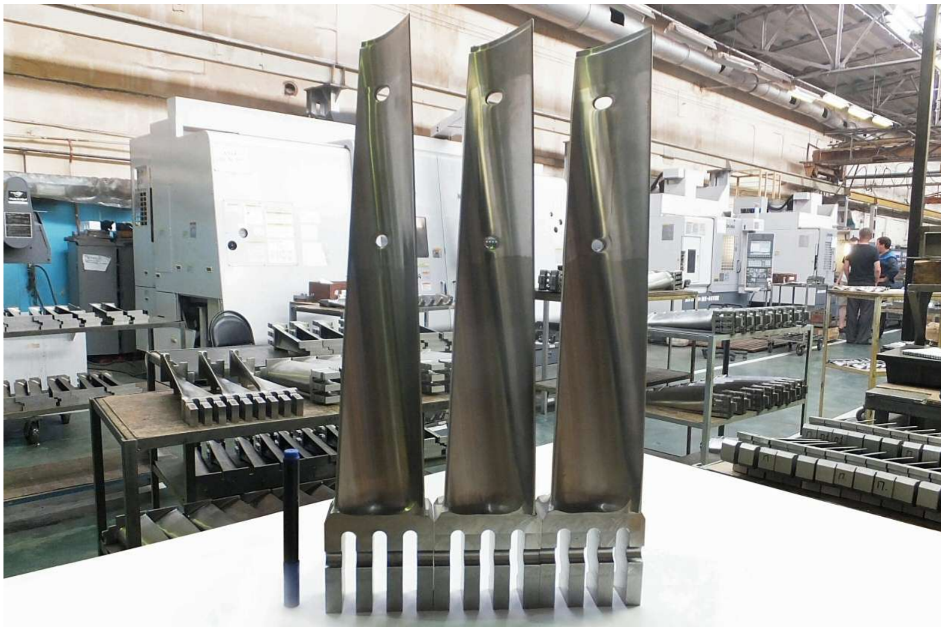
Рабочие лопатки 8 ст. РСД Паровая турбина К-110-130 (УТЗ)
