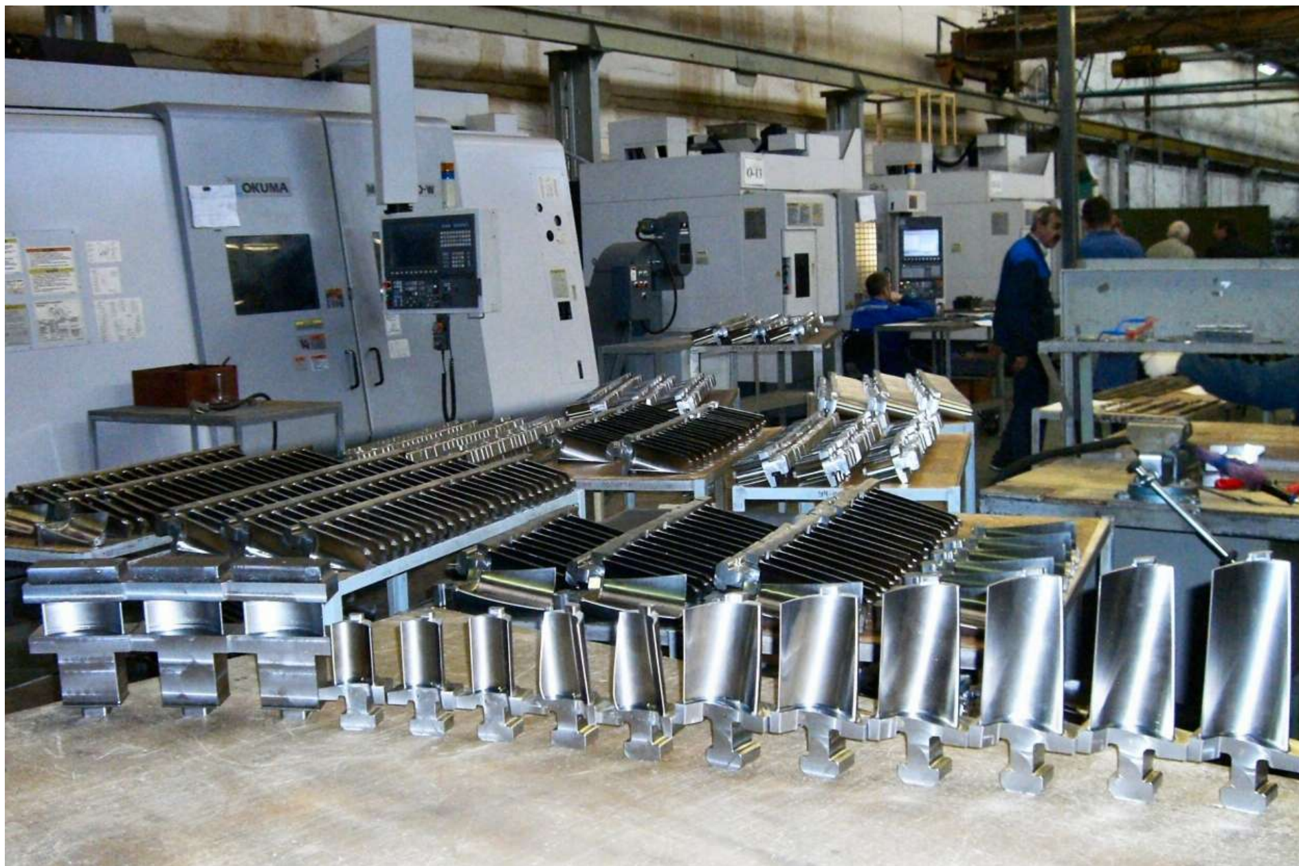
Рабочие лопатки 1-12 ст. РВД Паровая турбина К-500-240 (ЛМЗ)
