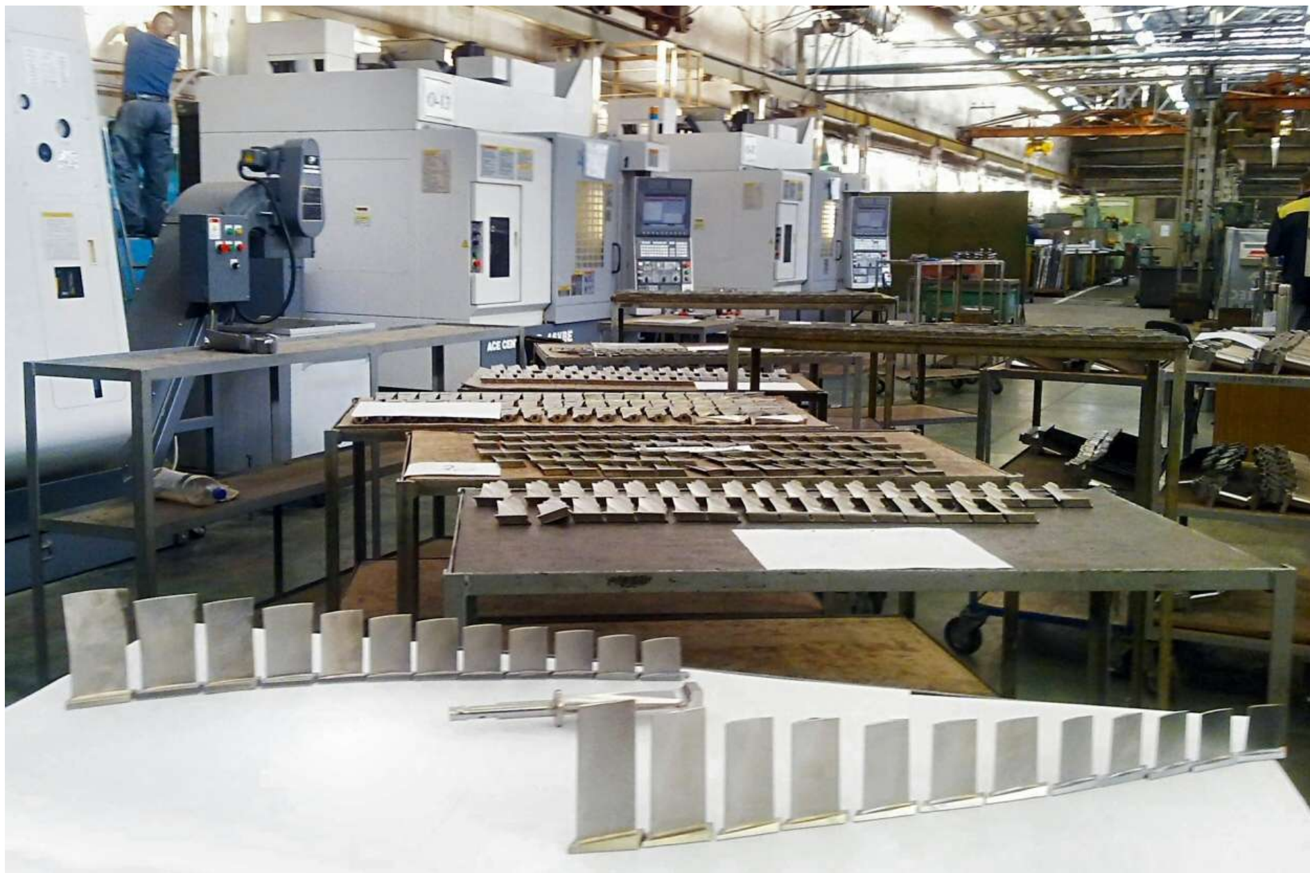
Рабочие и спрямляющие лопатки 1-12 ст. лопатка ВНА компрессора Газовая турбина ГТУ-8
