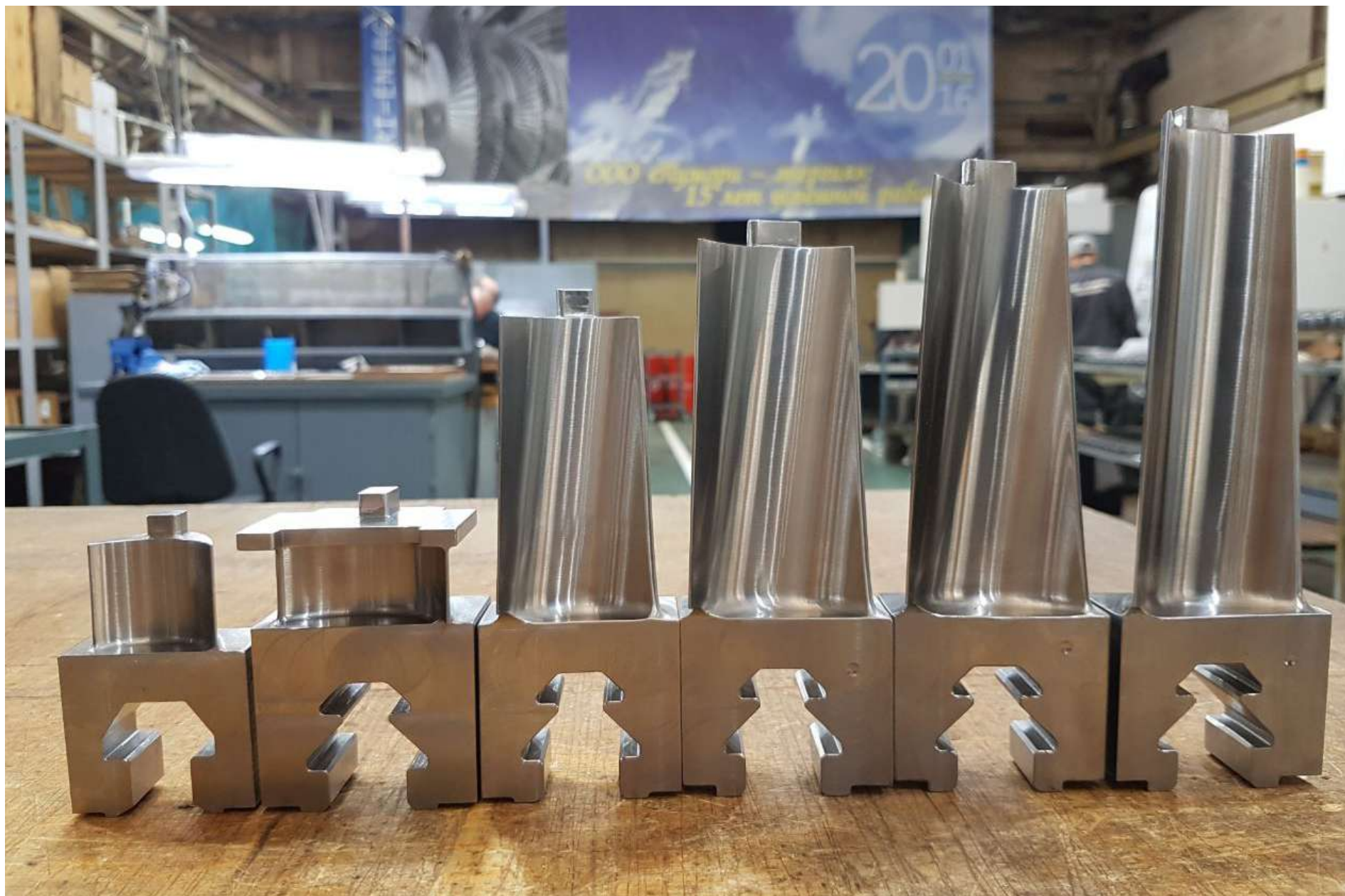
Рабочие лопатки 1-6 ст. паровой турбины К-300-240 (ХТГЗ)
