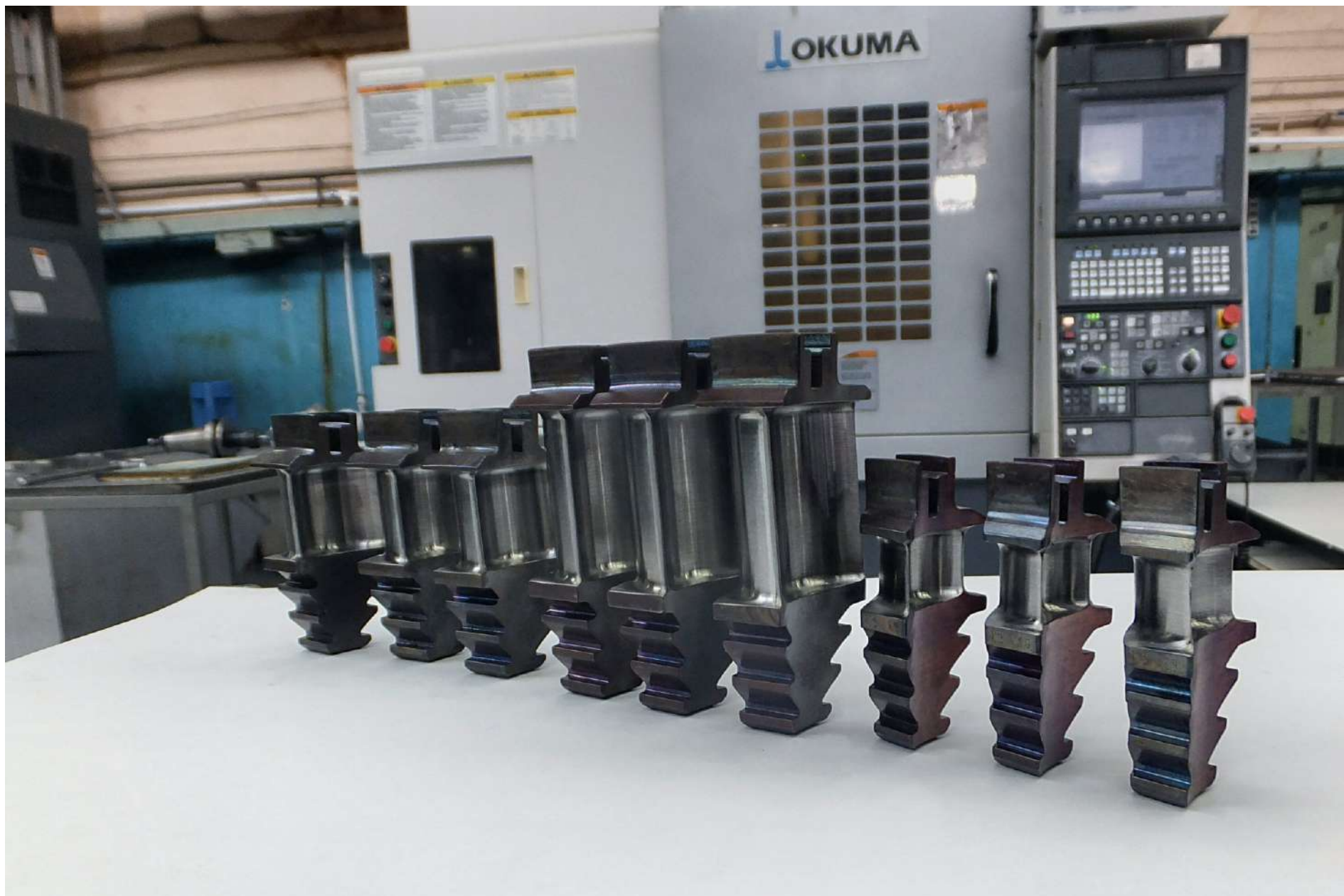
Рабочие лопатки паровой турбины П-30 (НЗЛ)
