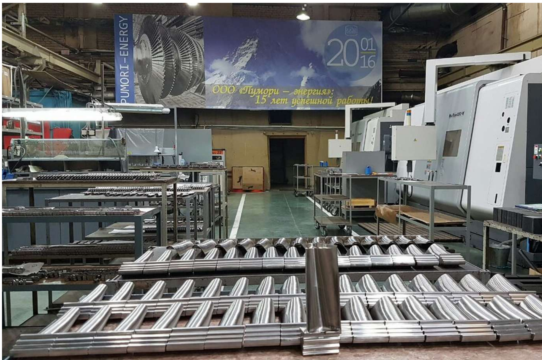
Рабочие лопатки 2 ст. газовой турбины ГТТ-12 (НЗЛ)
