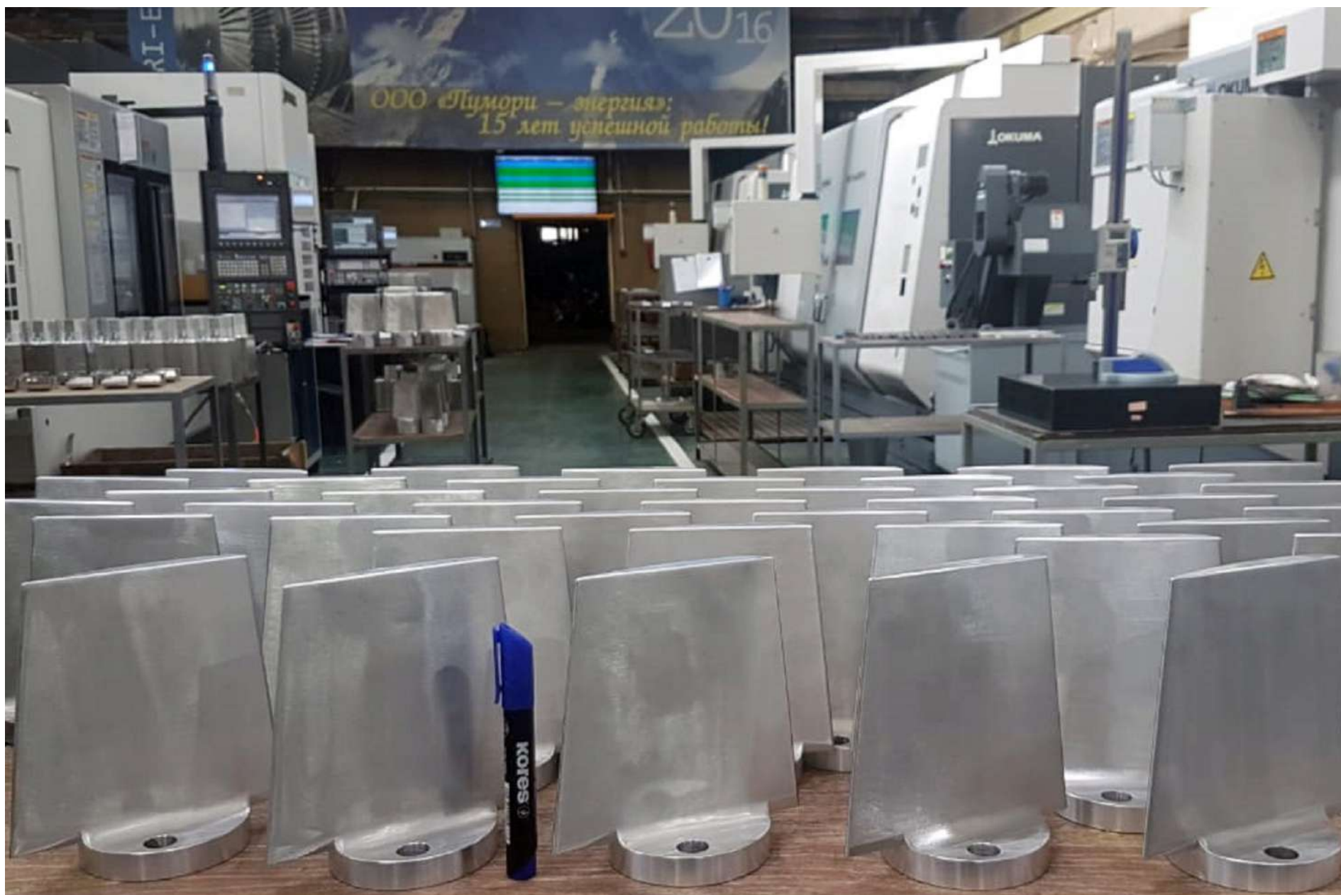
Лопатки вентилятора гидротурбогенератора
