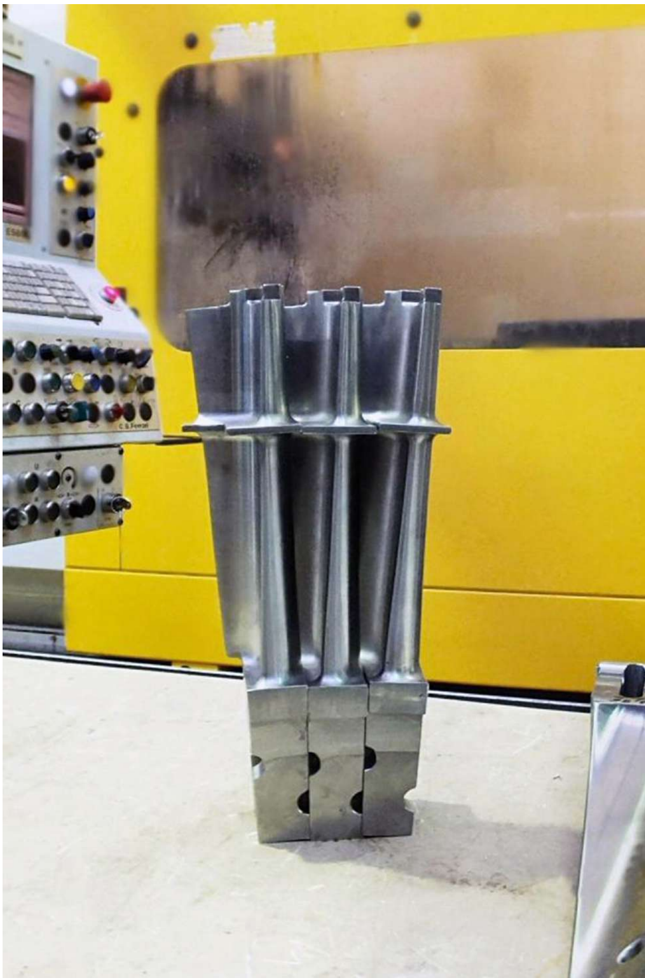
Рабочие лопатки 25 ст. Паровая турбина ПТ-60-90/13 (ЛМЗ)
