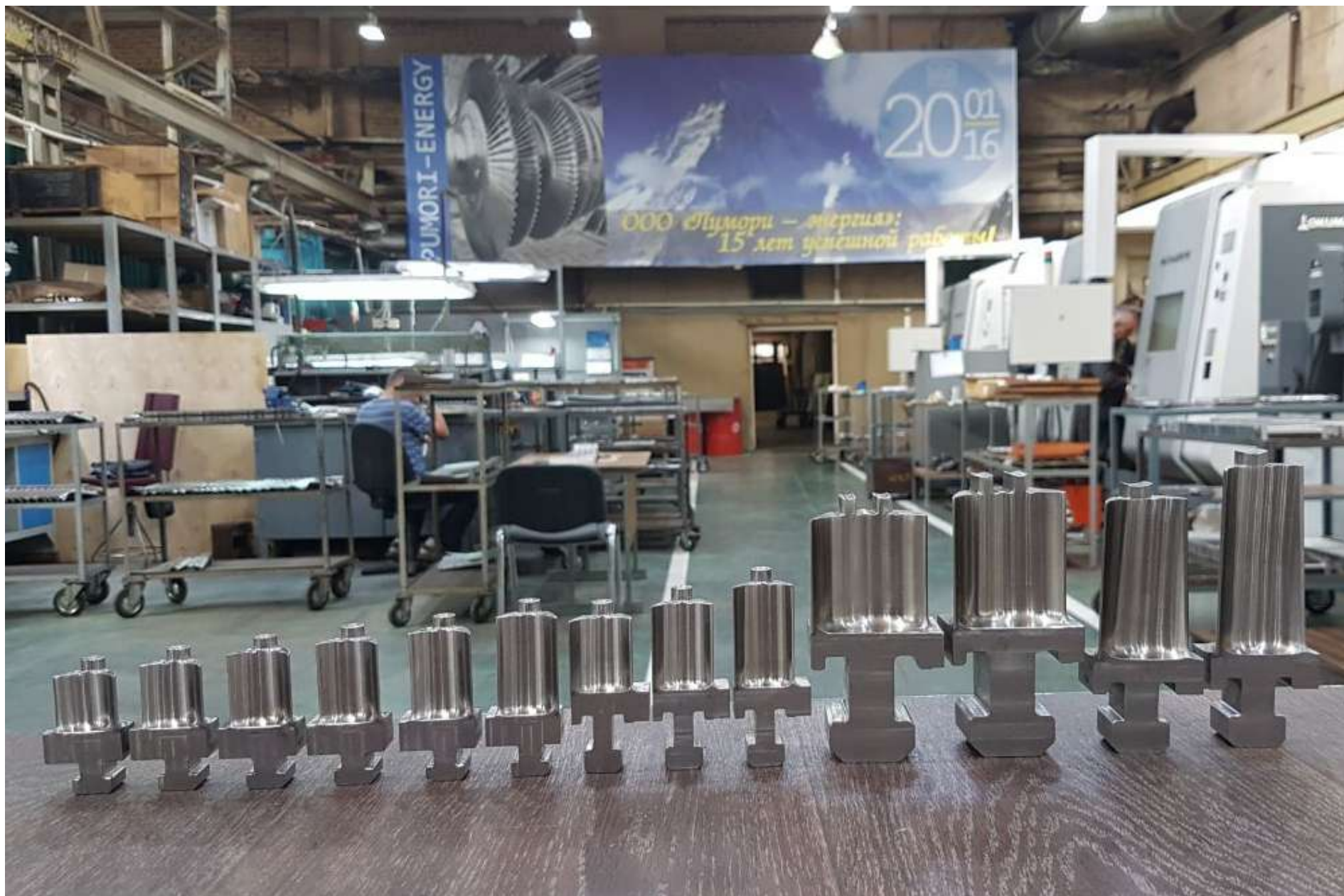
Рабочие лопатки 4-16 ст. паровой турбины К-65-12,8 (УТЗ)
