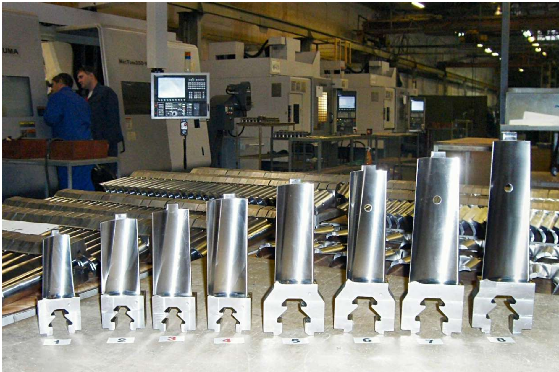
Рабочие лопатки 1-8 ст. РСД Паровая турбина К-300-240 (ХТГЗ)
