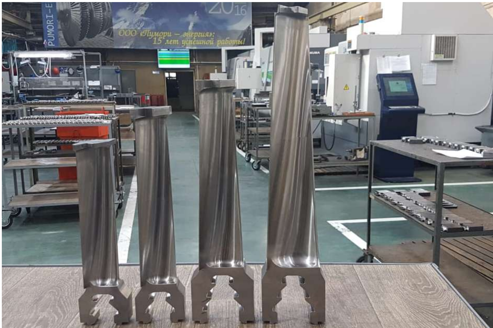
Рабочие лопатки 20, 21, 22 и 25 ст. турбины Тп-115 (УТЗ)
