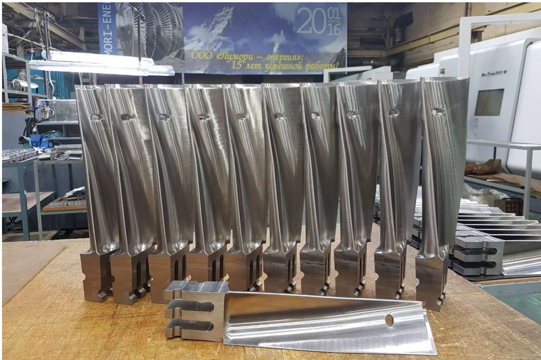
Рабочие лопатки 35 ст. паровой турбины Т-295-240 (УТЗ)
