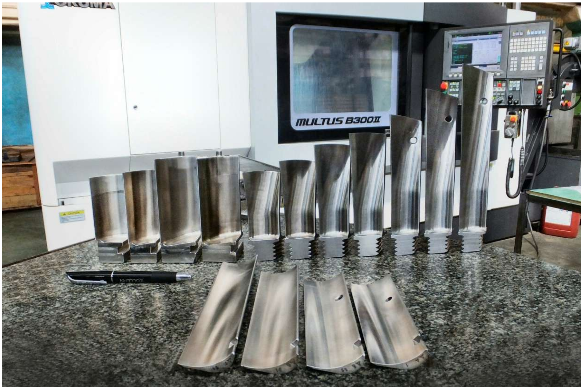
Рабочие и направляющие лопатки 1-7 ст., Газовая турбина ГТТ-3М (НЗЛ)
