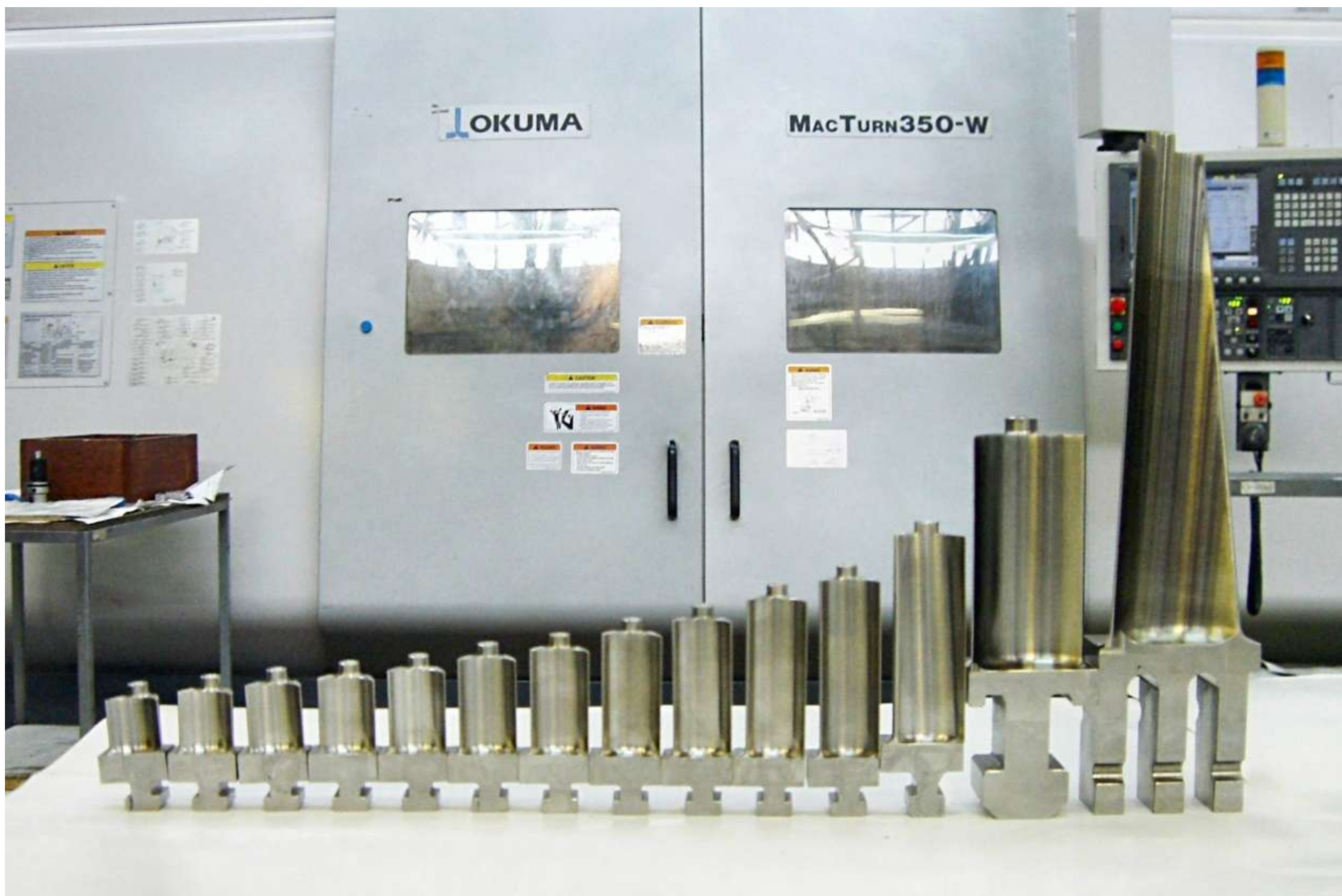
Рабочие лопатки 1-13 и 17 ст. Паровая турбина Т-63-90 (УТЗ)
