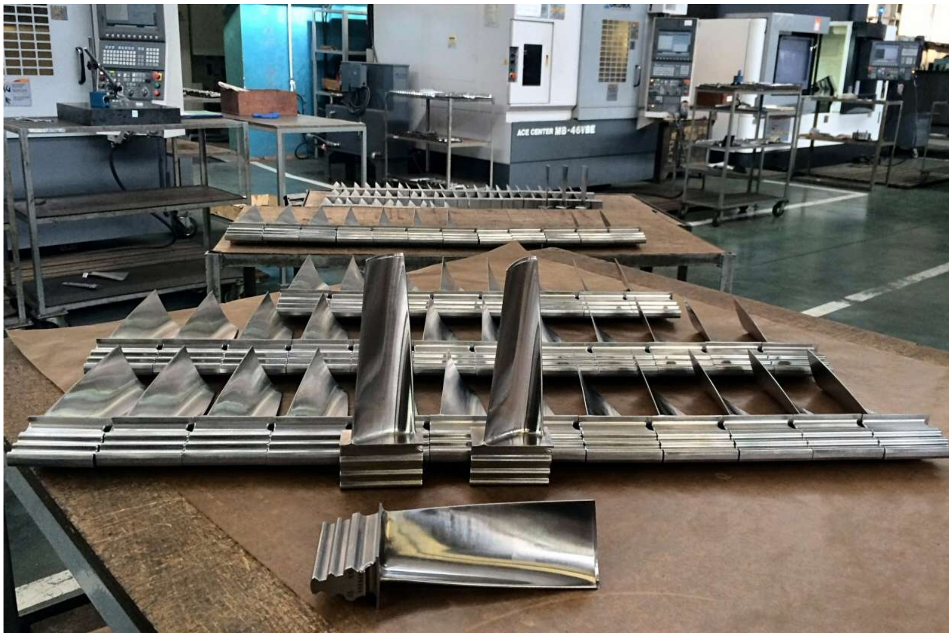
Рабочие лопатки 4 ст. Газовая турбина ГТН-6 (УТЗ)
