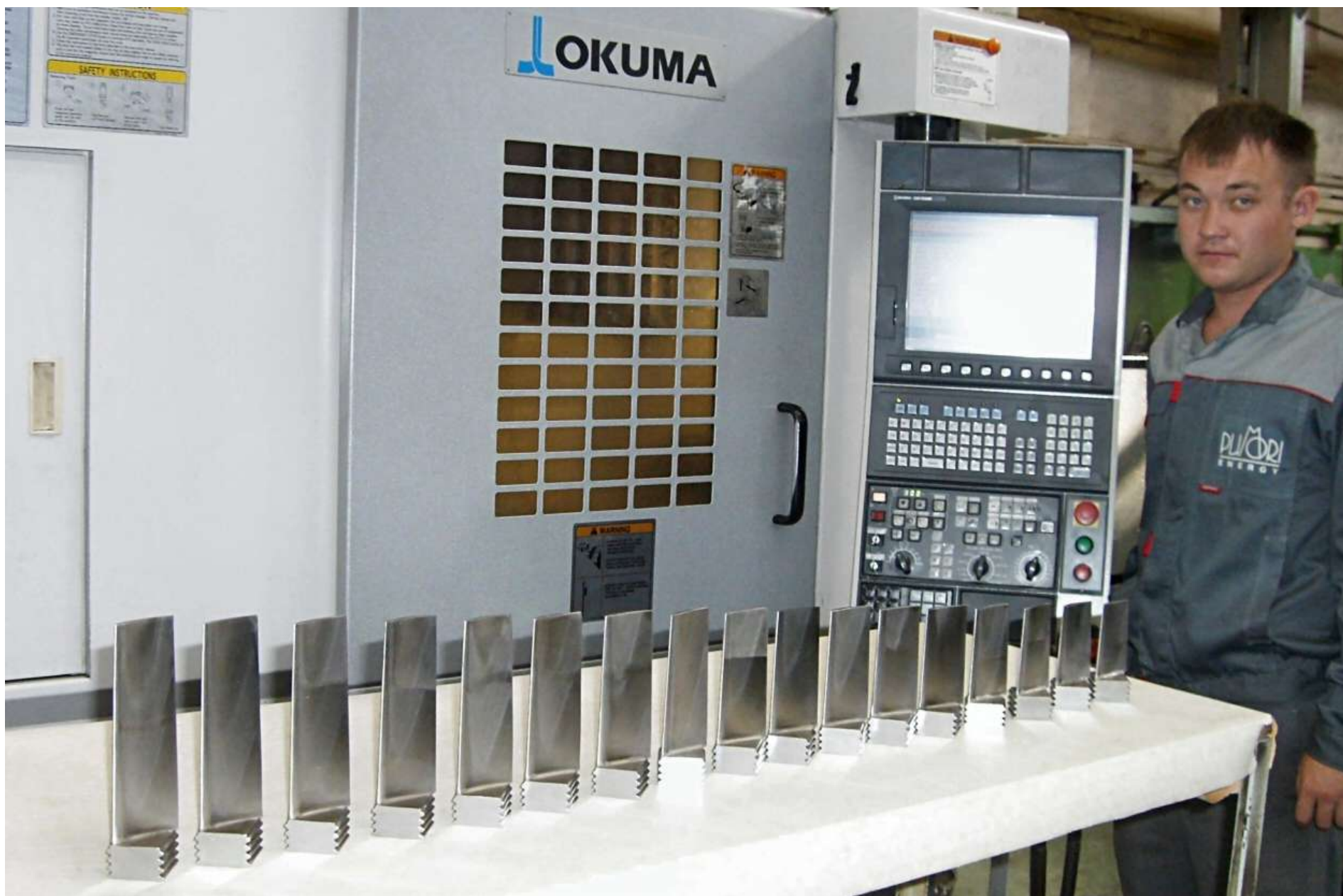
Рабочие лопатки 0-16 ст. компрессора Газовая турбина ГТТ-3М (НЗЛ)
