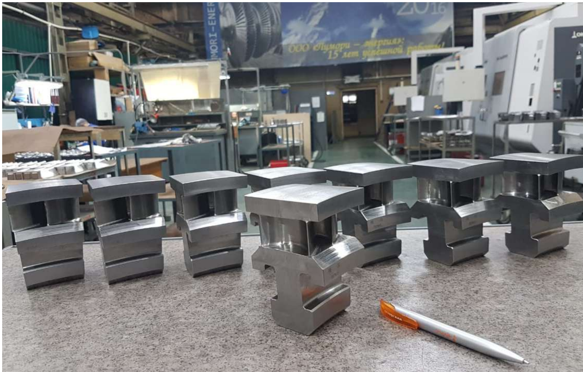
Пакеты рабочих лопаток 1 ст. турбины ПТ-135-130, изготовленные без сварки
