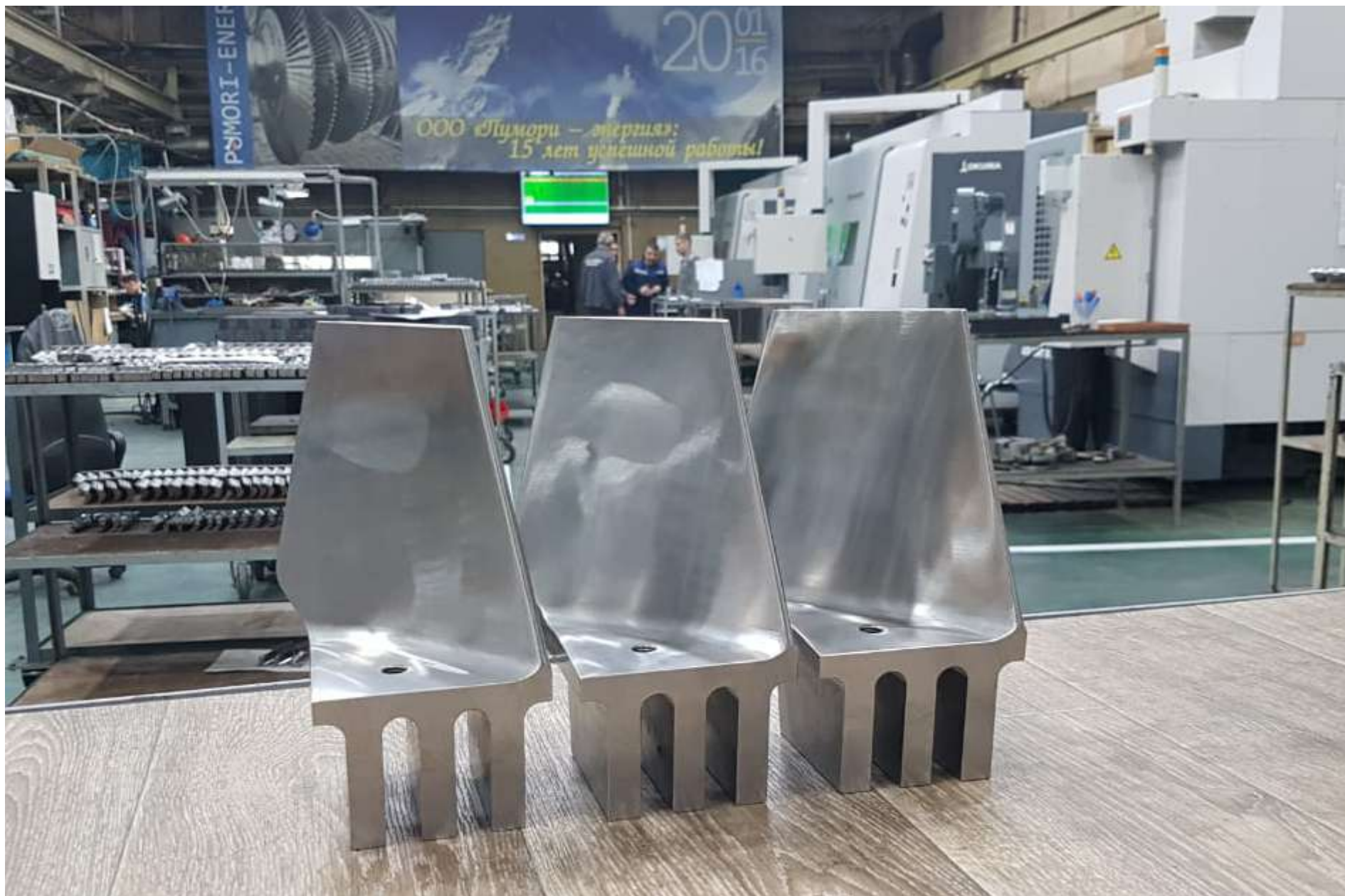
Лопатки вентилятора генератора (ЭЛСИБ)
